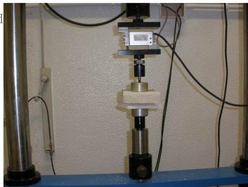
Figura 3 - Provete ensaiado à tensão de aderência
